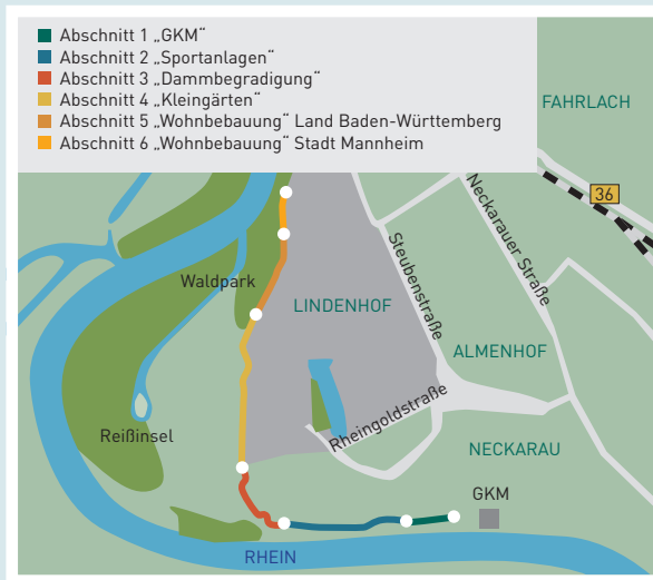
Rheindammsanierung in sechs Abschnitten (Grafik: magenta)
